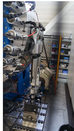
Rig RIR 400 avec un total de 320 boulons (M30 à M60)
