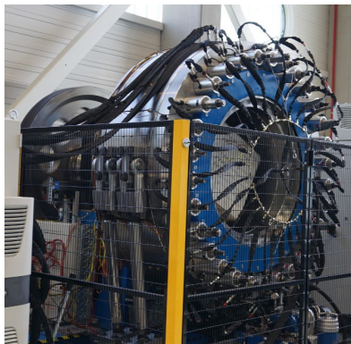
Rig RIR 400 avec un total de 320 boulons (M30 à M60)
